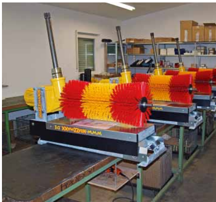
Es werden immer Kleinlose von acht bis zehn Maschinen gefertigt. Ein Mitarbeiter übernimmt dabei die komplette Montage.
